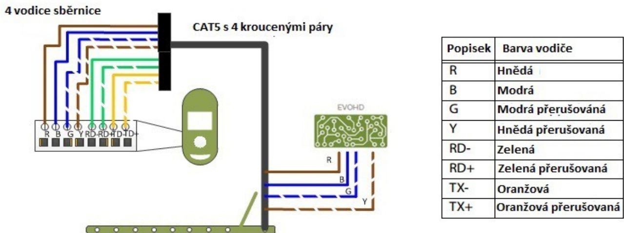
Obrázek 1 : Doporučené zapojení s použitím CAT5 kabelem nebo vyšším
